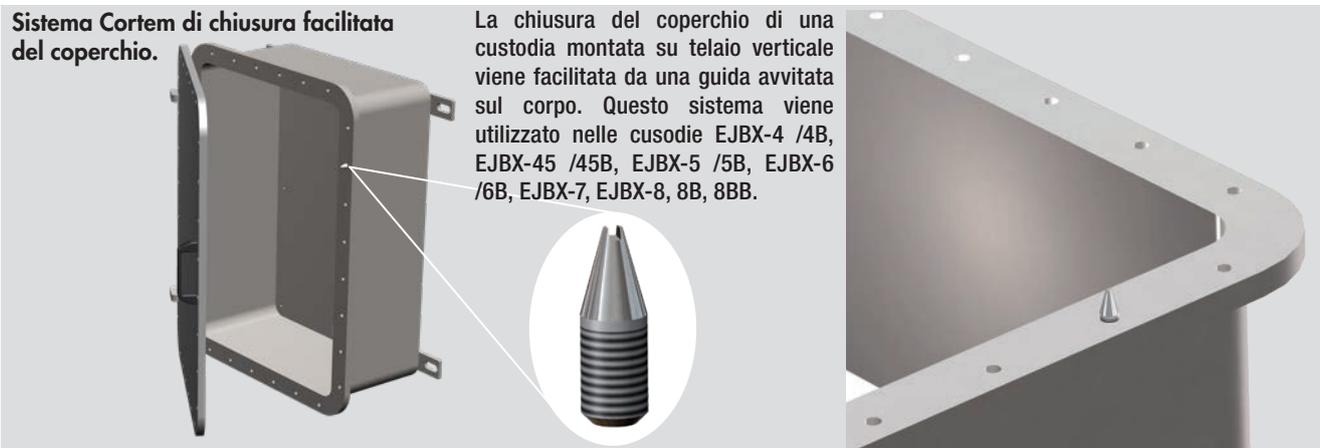
La chiusura del coperchio di una custodia montata su telaio verticale viene facilitata da una guida avvitata sul corpo. Questo sistema viene utilizzato nelle custodie EJBX-4 /4B, EJBX-45 /45B, EJBX-5 /5B, EJBX-6 /6B, EJBX-7, EJBX-8, 8B, 8BB.
