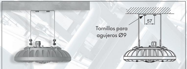
Montaje a techo modelo alto TIPO "U"
