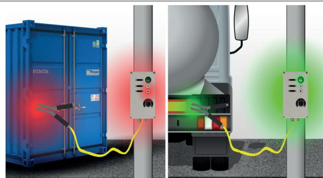
*Segnale di stato al sistema di gestione carico, per avvio pompa e apertura valvola di carico*
