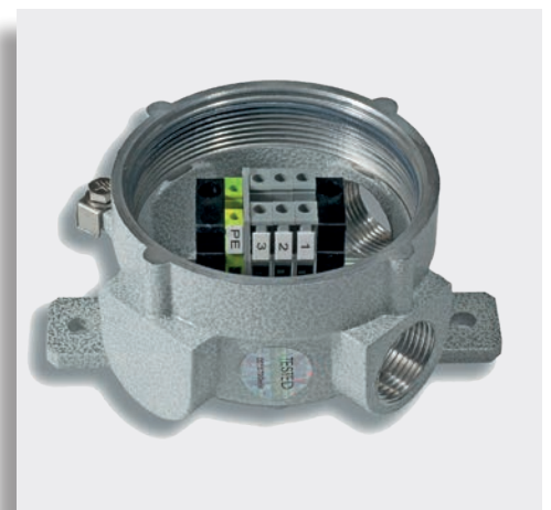
Caja tipo SFL-26.1 con 3 bornas RP-4 y 1 borna de tierra TR-2
