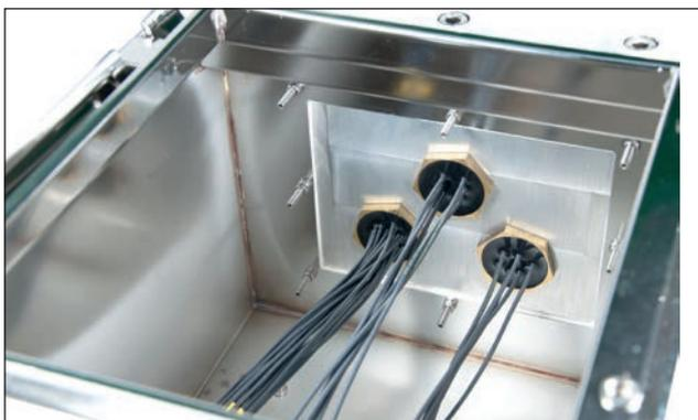
Conexión realizada mediante pasacables sellados serie TP Cortem de cobre niquelado o acero inoxidable. El número y el diámetro de los pasacables sellados dependen del número y de la sección de los cables. La protección IP entre las cajas está asegurada por una junta plana de silicona.
