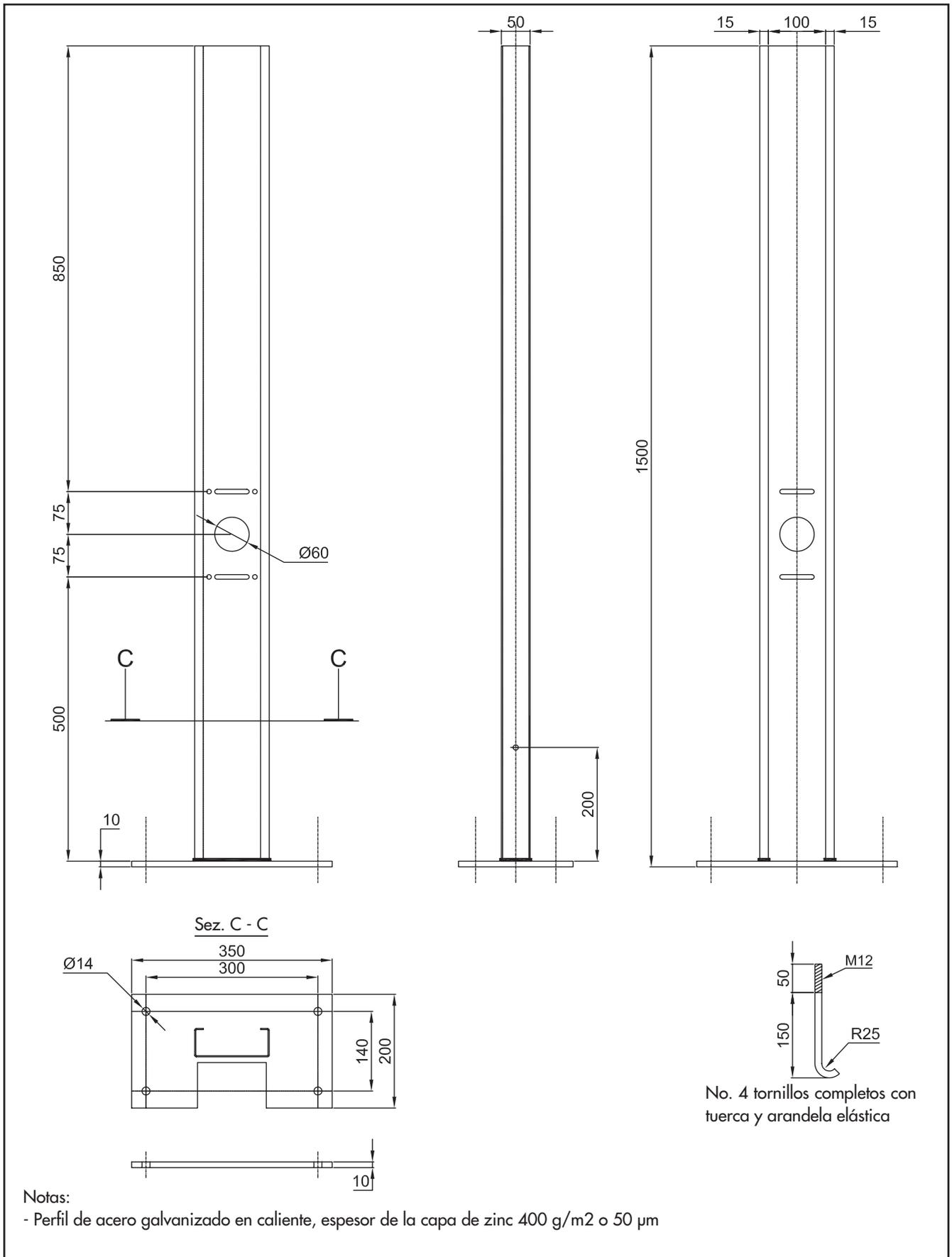
Soporte para equipos, instalación en estructura.
