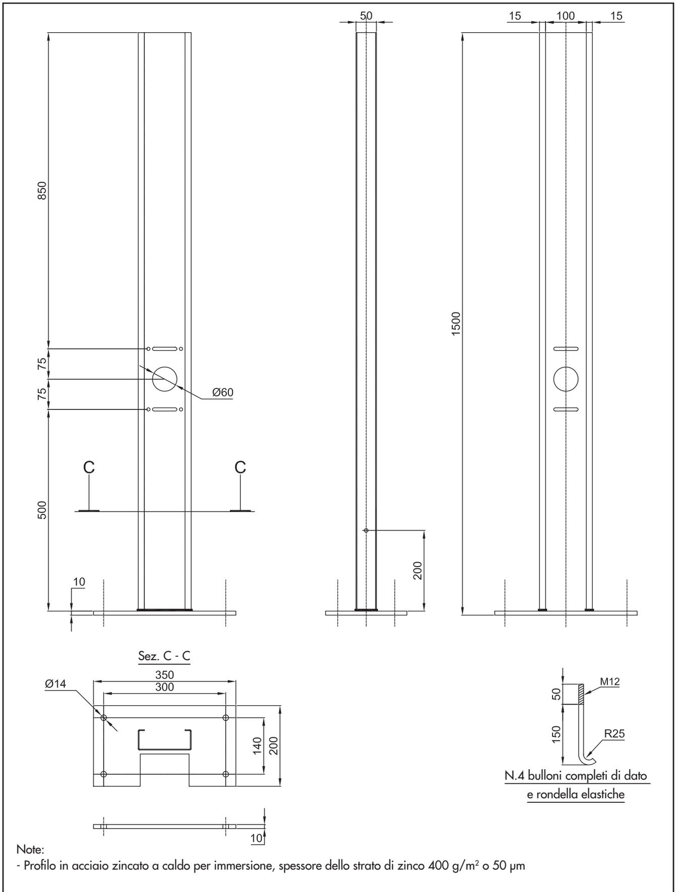
Supporto apparecchiature, installazione su struttura.
