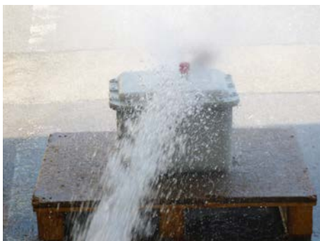
Fig. 21 Prueba de grado de protección IP X6
