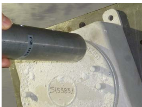
Fig. 19 Prueba de impacto a 7J sobre una envolvente de la serie GUB, con doble ciclo de celda climática a -65^{\circ}\text{C}
