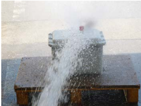
Fig. 21 Prueba de grado de protección IP X6
