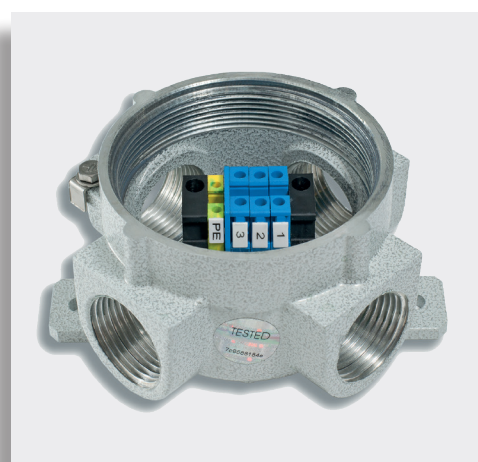
Caja tipo SFL-36.1 con 3 bornas RP-4EXI y 1 borna de tierra TR-2
