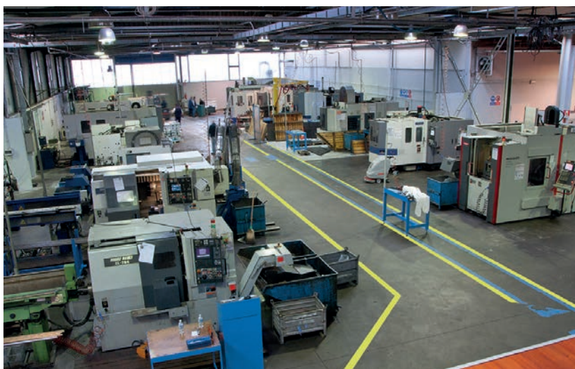
Fig. 17 Parte del departamento de taller equipado con centros de mecanizado horizontales y verticales, tornos CNC, Transfer y accesorios.
