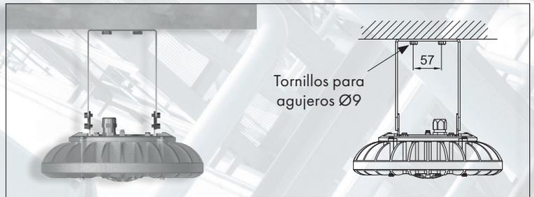
Montaje a techo modelo alto TIPO "U"
