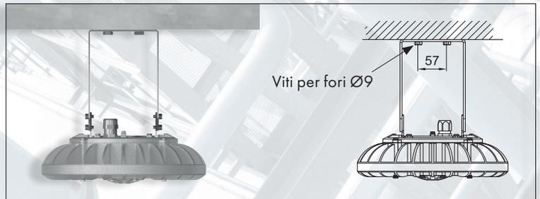
Montaggio a soffitto modello alto TIPO "U"
