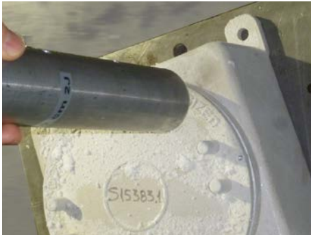
Fig. 19 Prova d'urto a 7J su una custodia serie GUB dopo un ciclo in cella climatica a -65°C
