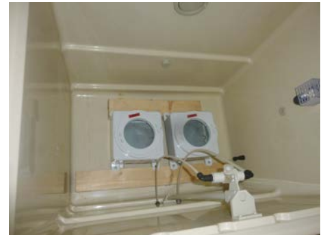
Fig. 20 Custodie testate in nebbia salina
