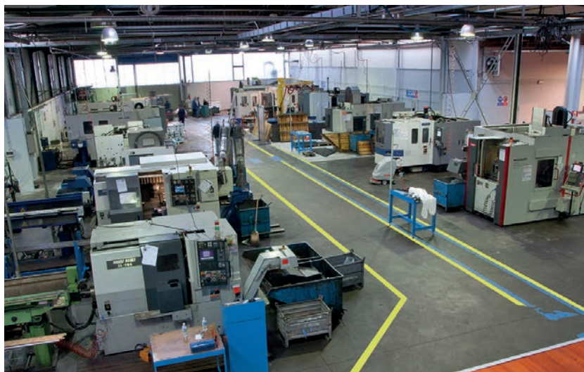
Fig. 17 Parte del reparto off cina dotato di centri di lavoro orizzontali e verticali, torni CNC, Transfer e attrezzatura.
