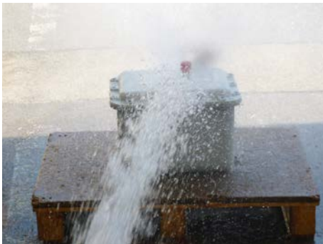
Fig. 21 Test grado di protezione IP X6
