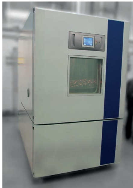
Fig. 18 Cella climatica del Laboratorio Cortem Group in cui viene testata la resistenza termica dei prodotti
