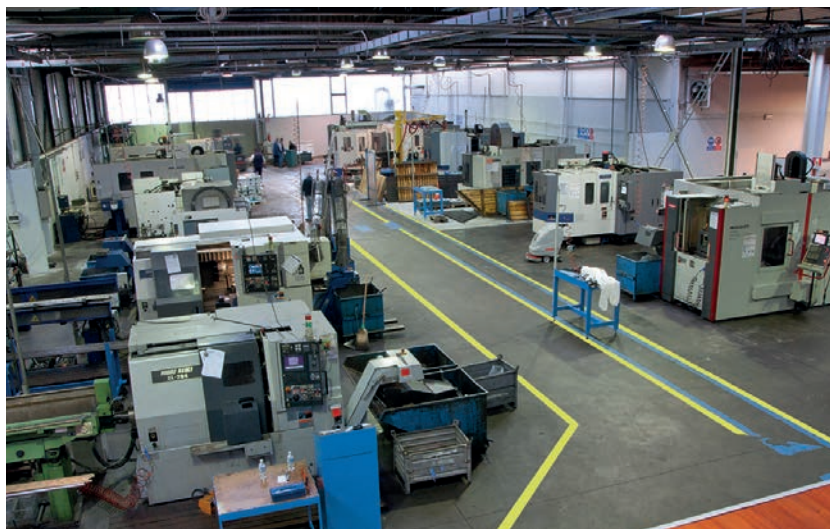
Fig. 17 Parte del reparto officina dotato di centri di lavoro orizzontali e verticali, torni CNC, Transfer e attrezzatura.
