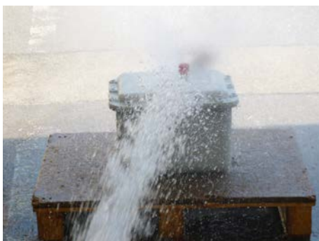
Fig. 21 Test grado di protezione IP X6
