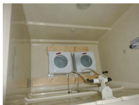
Fig. 20 Custodie testate in nebbia salina
